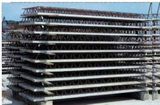
Obr. 2 - Skladování stropních trámů
