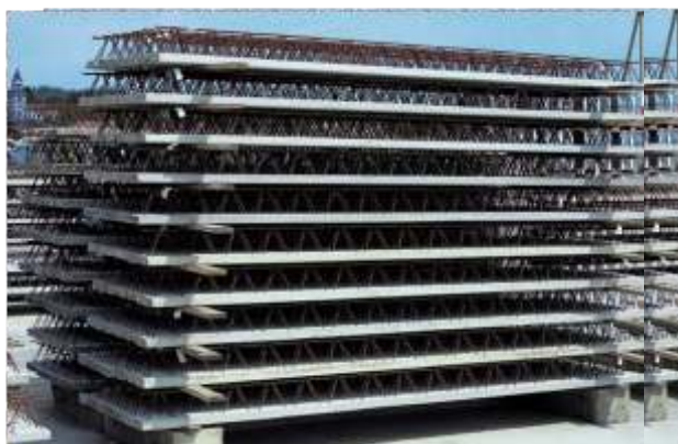
Obr. 2 - Skladování stropních trámů
